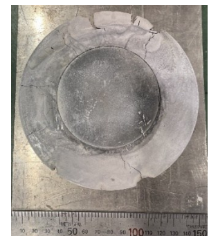
図 3 試験片（薄肉部：1 mm）
