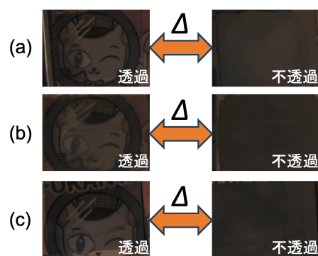
図 1 SudanBlack を含む液晶セルの透過ー不透過挙動: (a) 0.1mol; (b) 0.3mol; (c) 0.5mol;
